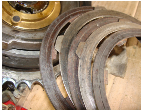
Photo 2 : disques d'embrayage. 5 disques, 3 avec garniture, 2 en acier
